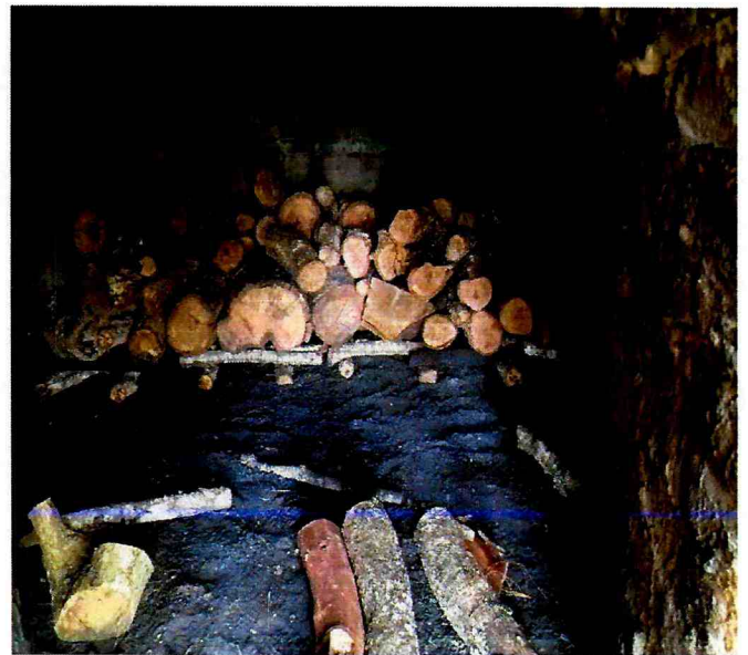
Fotografía 8. Ordenamiento de la madera dentro del horno para el proceso de carbonización.
