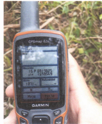
Figura 4 Obtención de coordenadas UTM
