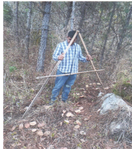
Figura 3 Obtención del porcentaje de la pendiente
