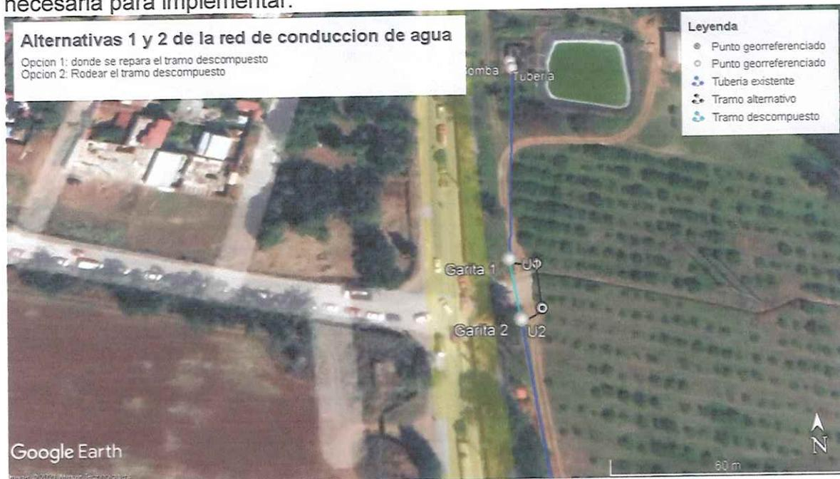
*Ilustración 2: Opciones para reparaciones del sistema de conducción*
