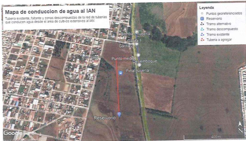
Ilustración 1 Mapa del sistema de conducción de agua según los puntos georreferenciados.
