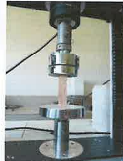
Ilustración 8 Prueba de tensión paralela al grano
