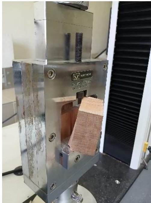
Figura 26 A Elaboración de prueba de corte paralelo al grano
