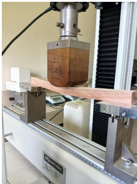
Figura 22 A Elaboración de prueba de flexión estática
