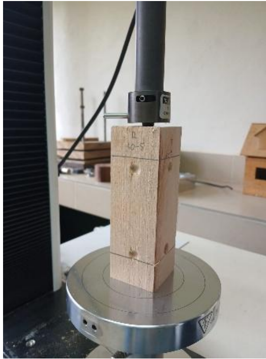
Figura 26 A Elaboración de prueba de corte paralelo al grano
