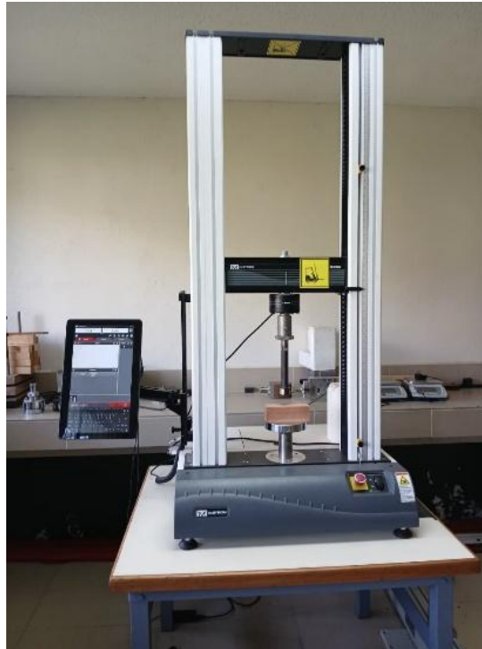
Figura 22 A Elaboración de prueba de flexión estática
