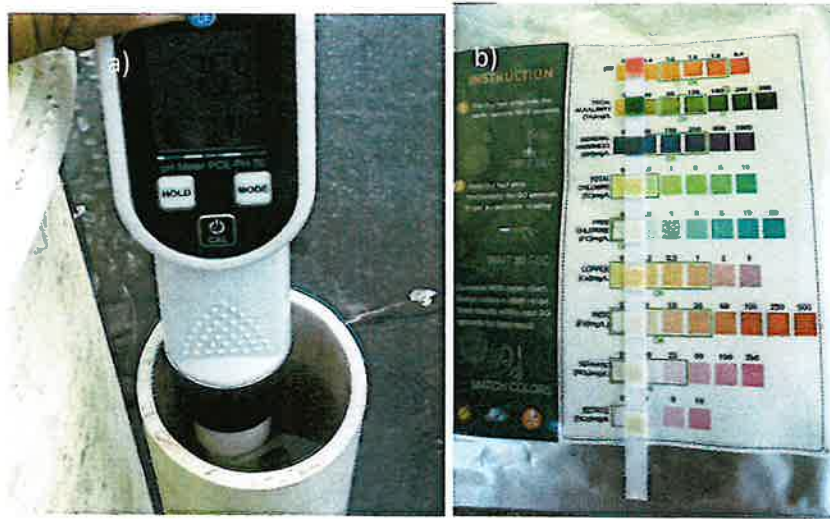
Figura 8. a) Medición de calidad del agua con pHachímetr . b) Resultado de tiras para para control de parametros de pH, alcalinidad, cloro, cobre, hierro, nitritos y nitratos.
